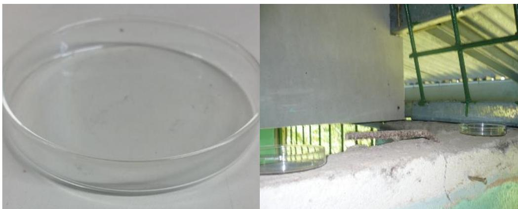
Figura 10: Muestreador pasivo de aire, caja petri
