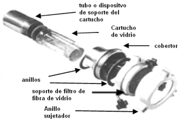
Figura 8: Imagen del muestreador de aire activo
