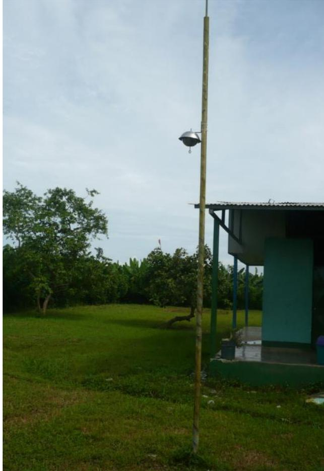
Figura 6: Muestreador pasivo de aire.
