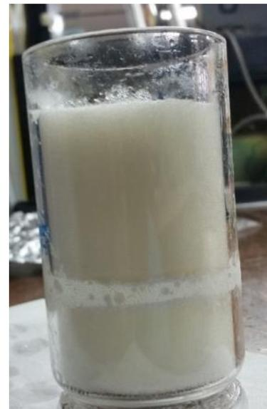
Figura 7: Dispositivo de vidrio con una resina de XAD de Supelco
