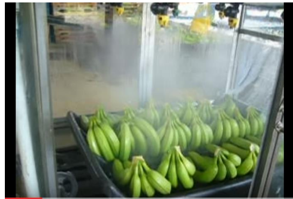
Figura 2. Cámaras de fumigación del tiabendazol en el área de empaque. Tomado de:
